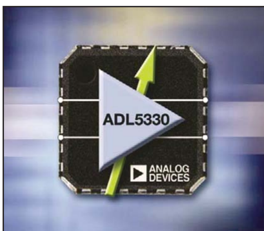
Корпус типа LFCSP размерами 4×4 мм
