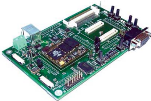
Рис. 5. Оценочная плата DEV-Blackfin Development board
